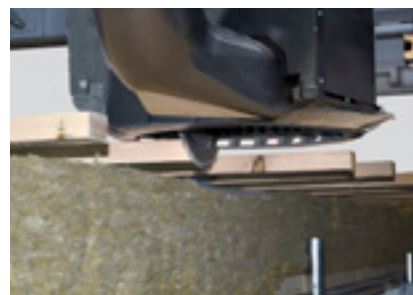
Formatowanie łąt dachowych
