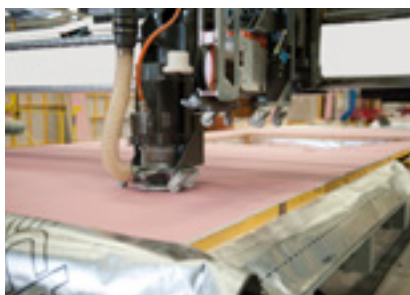
Obróbka płyt kartonowo-gipsowych
