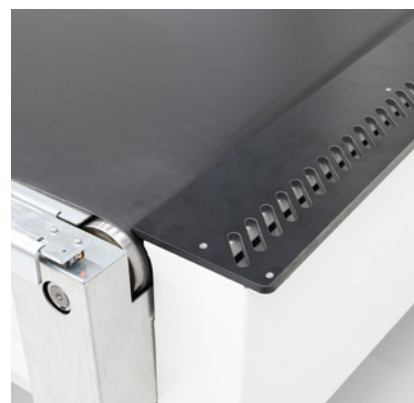
Odciąg na końcu pasa
