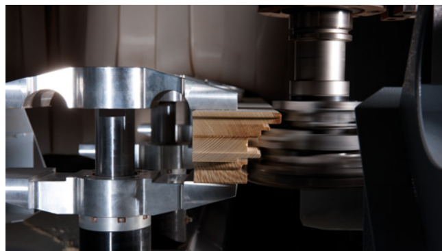
Chłodzone ciecżą wrzeciona frezarskie z regulacją wektorową
