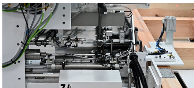
Agregat śrubujący do przykręcania ryglówek.
