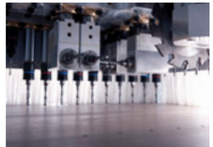
Tecnologia de furação de alta velocidade com serra de ranhura
