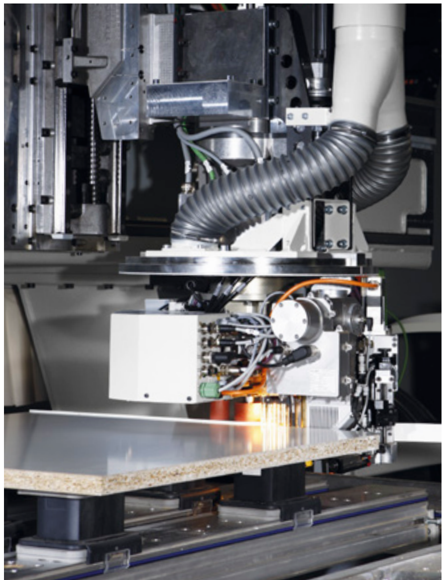
laserTec Colagem de bordas perfeitas sem junta de cola
