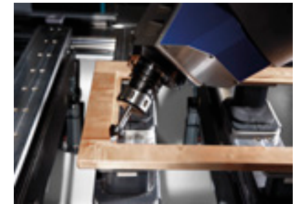
Usinagem de quinas para rebaixo de janela
