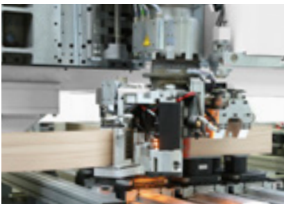
Colagem de bordas para peças de até 100 mm de altura
