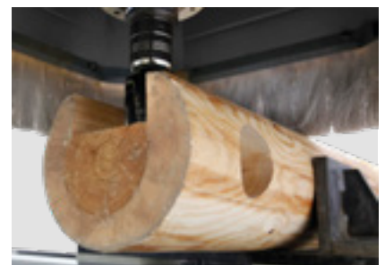
Dispositivos de fixação para blocos: Dispositivo de fixação adaptado para blocos para usinar componentes redondos de madeira.
