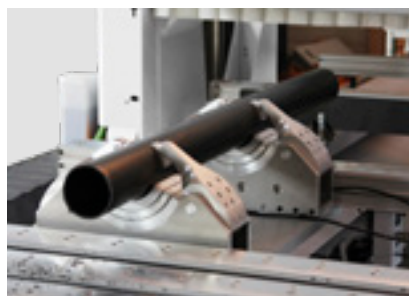
Dispositivo de fixação para tubos redondos: Dispositivo de fixação para usinagem de 5 eixos de tubos redondos de plástico.
