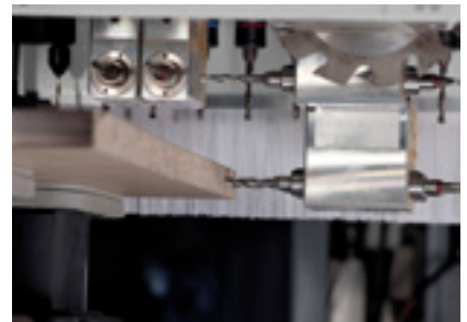
Furação horizontal para encaixes de conexões
