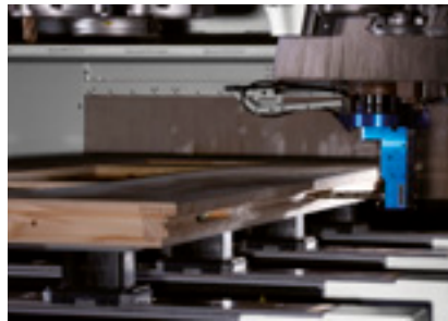
Usinagem de caixas de fechadura em portas
