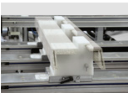
Dispositivos de fixação especiais: Dispositivo de fixação a vácuo para peças dobráveis e ornamentais de acordo com as especificações do cliente. Montado em um módulo de placa base.
