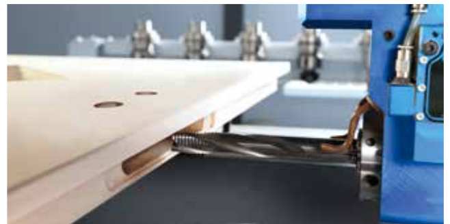
Frézovanie otvorov pre zámok
