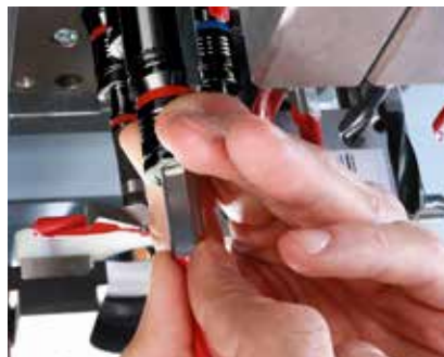
Patentovaný systém rýchlej výmeny na výmenu vrtákov bez použitia náradia, ktorý skraca čas potrebný na nastavenie.
