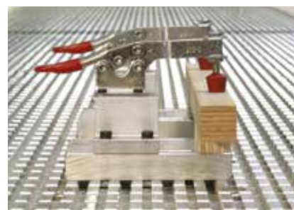
Upevnenie špeciálnych upínacích prostriedkov Hliníkový rastrový stôl s rybinovými vodiacími lištami zabezpečuje presné upevnenie tvarových prvkov
