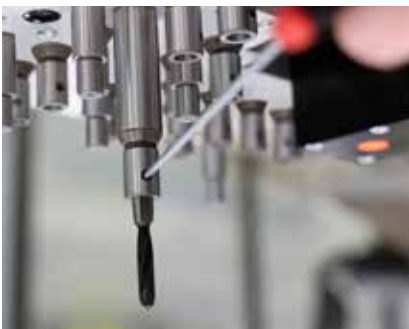
Výmenný systém Weldon pre výmenu vrtáka s nástrojmi
