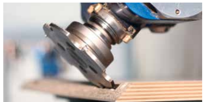
Frézovanie pre spojovacie kovania
