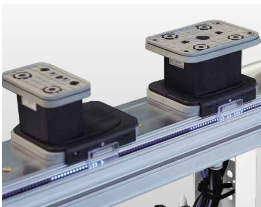
LED polohovacie systémy (voliteľné) LED svetlá ukazujú operátorovi presnú polohu, orientáciu a veľkosť prísaviek, ako aj polohu konzol pri až → 70% rýchlejšom polohovaní
