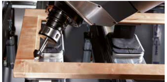
Frézování rohu skleneného falca
