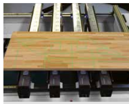
Laserová projekcia upínacieho zariadenia a kontúry obrobku pre optimálne využitie a jednoduché umiestnenie polotovarov, ktoré nie je možné vyrovať na dorazoch.
