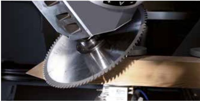
Skosený rez s velkou hloubkou rezu pro rámové díely
