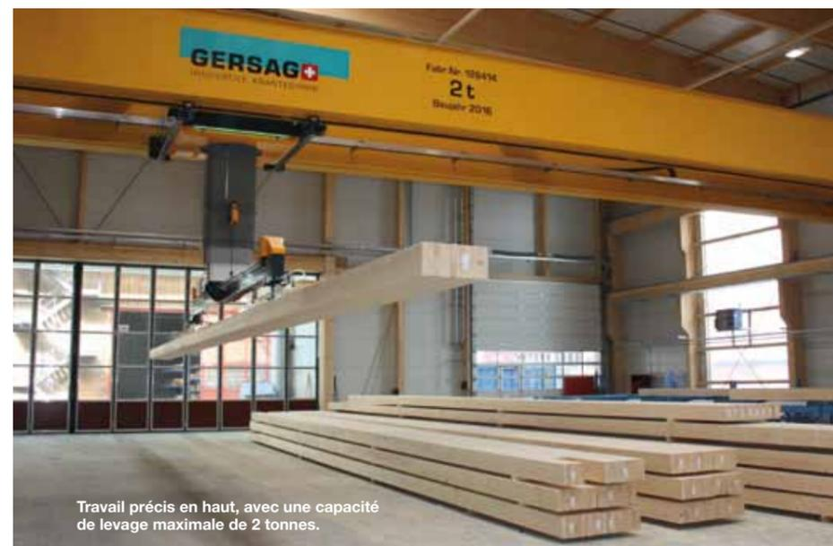
Travail précis en haut, avec une capacité de levage maximale de 2 tonnes.
