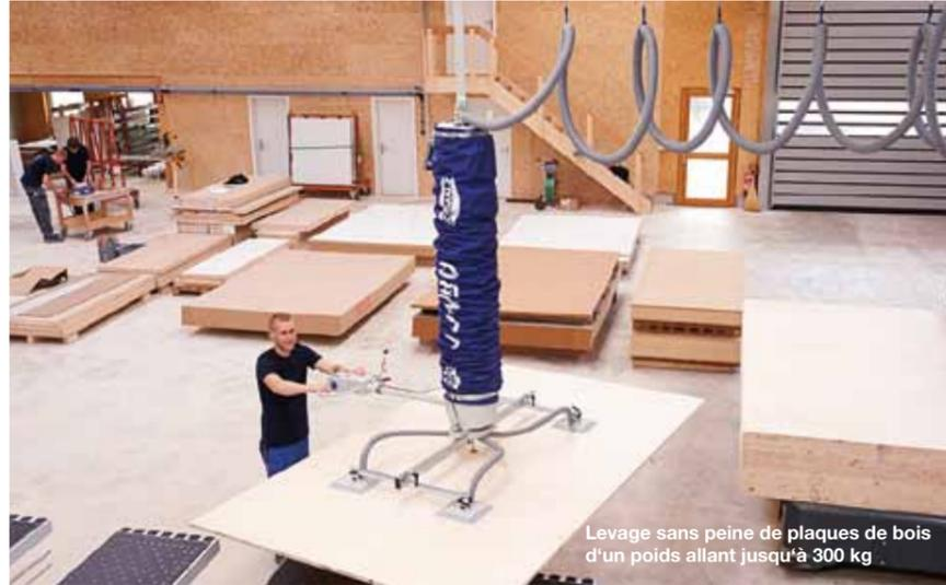
Levage sans peine de plaques de bois d'un poids allant jusqu'à 300 kg
