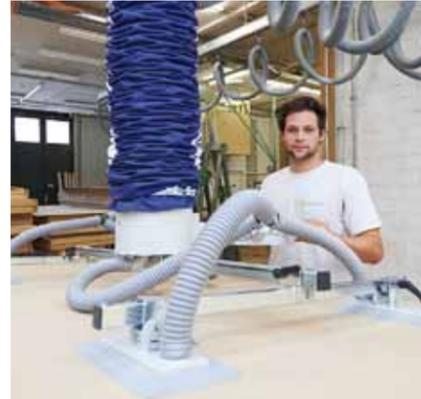
Bon pour le dos et rapide : le tube de levage par le vide Jumbo
