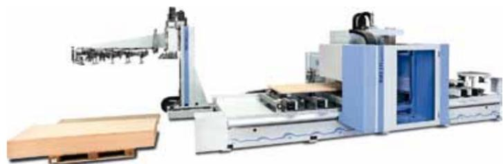
**Venture 230 / Profi BMG 211 de WEEKE – Centre d’usinage à CNC avec TBA**
